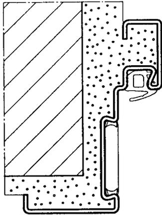
Wand aus Beton  $\geq$  140 nach DIN 1045
